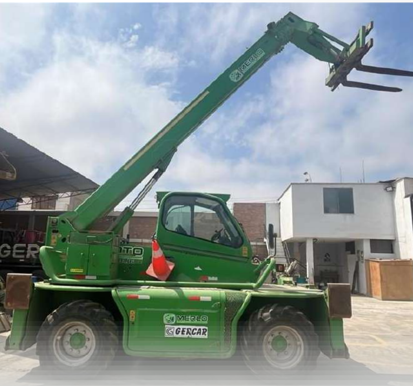
Marca: MERLO Modelo: ROTO 38.16 Tracción: 4x4 Año: 2011 Placa: TH-02 Long Pluma: 16mt Capacidad: 3.8tn
